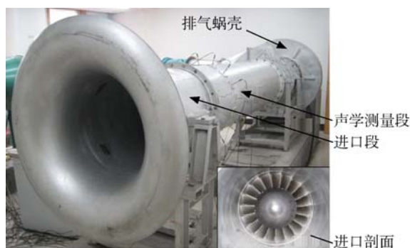
图1 单级风扇气动声学实验台
